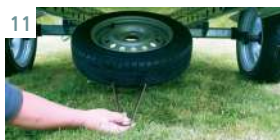
ERSATZRAD MIT HALTER | Praktische Anbringung unter dem Anhänger.
